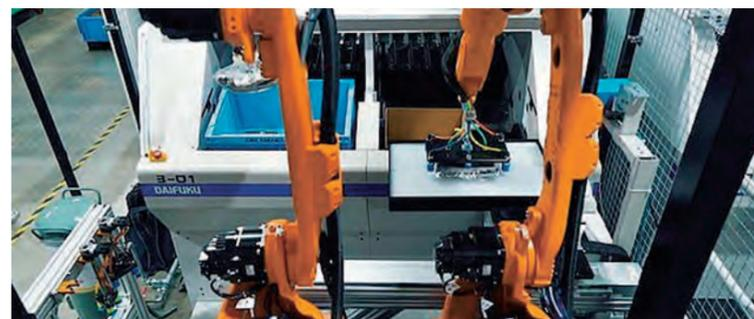
●Uniqlo使用的機器人叫做「智慧包裝機器人」，專門用於紡織品的折疊打包(圖片來源/鐸科技)
